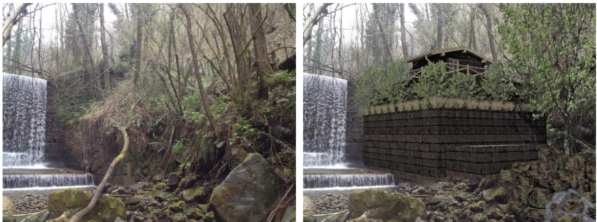
Figura 3-2: Stato attuale e stato di progetto con fotoinserimento dell'edificio che ospita i quadri di controllo e il locale turbine.
