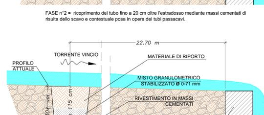
FASE n°3 = realizzazione di uno strato di misto granulare stabilizzato Ø 0-71 mm, anch'esso ottenuto filtrando il materiale di scavo, per circa 30cm; posa in opera di un ultimo strato di altezza variabile con l'utilizzo di materiale di scavo non setacciato; ripristino dello stato precedente l'inizio dei lavori.
