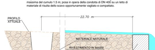
FASE n°2 = ricoprimento del tubo fino a 20 cm oltre l'estradosso mediante massi cementati di risulta dello scavo e contestuale posa in opera dei tubi passacavi.
