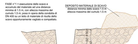
FASE n°1 = esecuzione dello scavo e successivo accumulo del materiale ad una distanza minima di 1.5 m, con altezza massima del cumulo 1.5 m; posa in opera della condotta di DN 400 su un letto di materiale di risulta dello scavo opportunamente vagliato e compattato.
